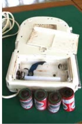
このように電池ボックスが錆びてしまうと、電池による非常電源機能がなくなります。1年を目安に、電池を交換しましょう。
