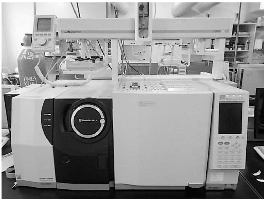
農薬分析機器 ガスクロマトグラフ質量分析計
