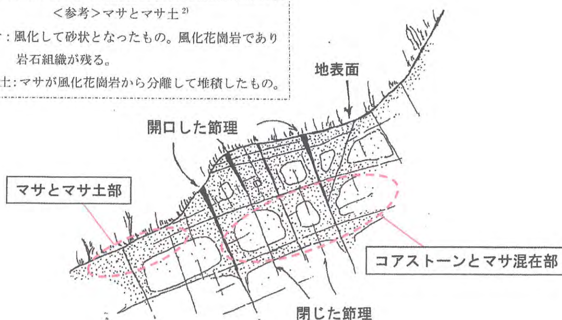
図-1 花崗岩の節理に伴う風化形態模式図 (1)より引用・加筆)
