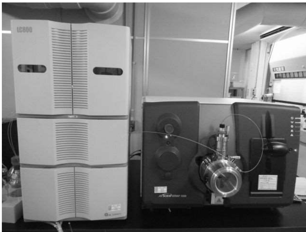
農薬分析機器 液体クロマトグラフ質量分析計
