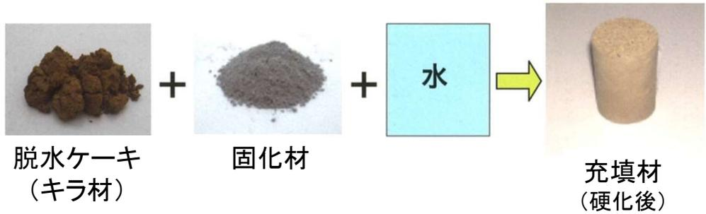
材料である脱水ケーキに固化材、水を混ぜたものが、充填材になります。
