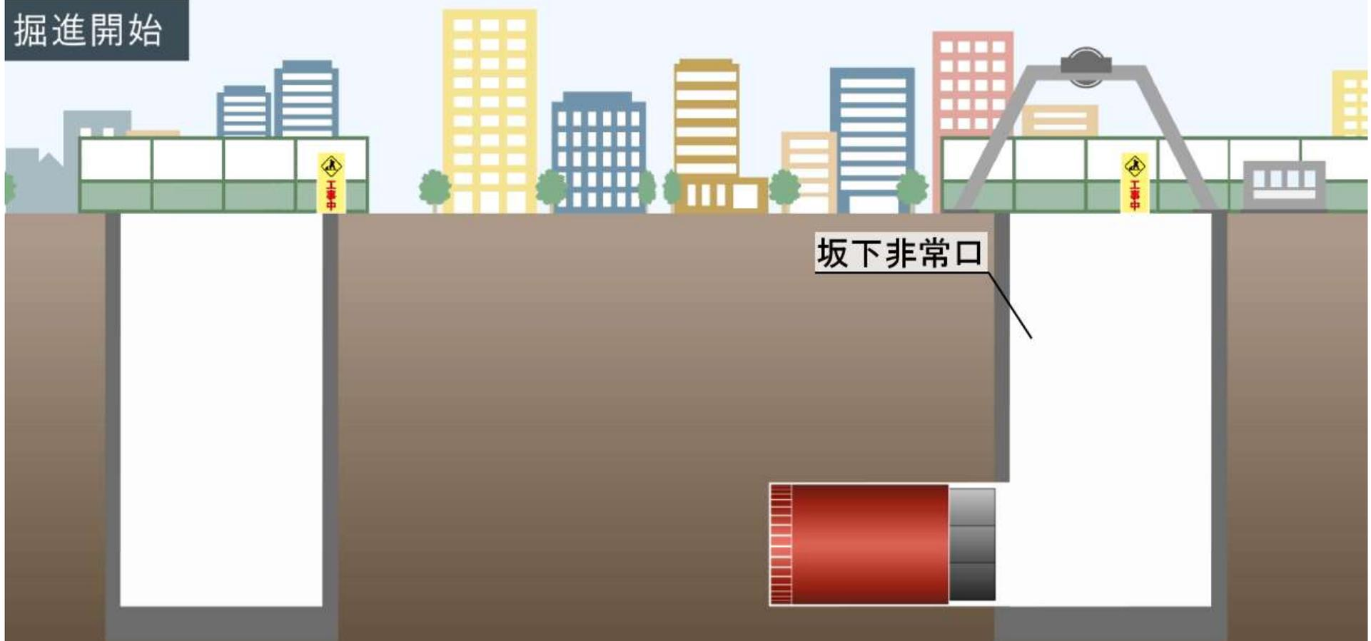
掘削した立坑から「シールドマシン」という筒状の掘削機を、地下へ搬入・組立をおこない隣り合う立坑に向けて掘り進めていきます。
